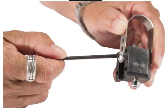
Dévisser la vis du feuillard (si nécessaire les deux vis, suivant le diamètre du châssis)
