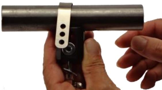
Placer le feuillard sur le châssis du fauteuil
