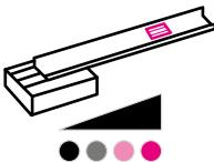
Las baterías de 11,4 Ah y 19 Ah incorporan un indicador de carga. Cada uno de los 4 LED representa el 25% de la capacidad total. Cuando el LED rojo empieza a parpadear, queda aproximadamente un 10% de batería. La batería debe recargarse después de cada día de uso.
