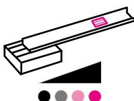
Un indicateur de charge est intégré à la batterie 11,4 Ah et 19 Ah. Chacune des 4 LED représente 25% de la capacité totale. Lorsque la LED rouge commence à clignoter, il reste environ 10% d'autonomie.
