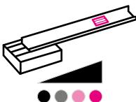
Nelle batterie da 11,4 Ah e 19 Ah è integrato un indicatore di carica. Ciascuno dei 4 LED rappresenta il 25% della capacità totale. Quando il LED rosso inizia a lampeggiare, la durata residua della batteria è di circa il 10%. La batteria deve essere ricaricata dopo ogni giorno di utilizzo.
