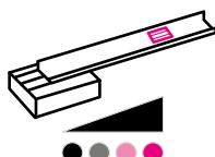
In die 11,4Ah- und 19Ah-Batterien ist eine Ladeanzeige integriert. Jede der 4 LEDs steht für 25% der Gesamtkapazität. Wenn die rote LED zu blinken beginnt, sind noch etwa 10% der Akkulaufzeit übrig. Der Akku muss nach jedem Tag der Nutzung aufgeladen werden.
