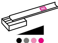
Um indicador de carga está integrado nas baterias de 11,4 Ah e 19 Ah. Cada um dos 4 LEDs representa 25% da capacidade total. Quando o LED vermelho começa a piscar, restam aproximadamente 10% da vida útil da bateria. A bateria deve ser recarregada após cada dia de utilização.
