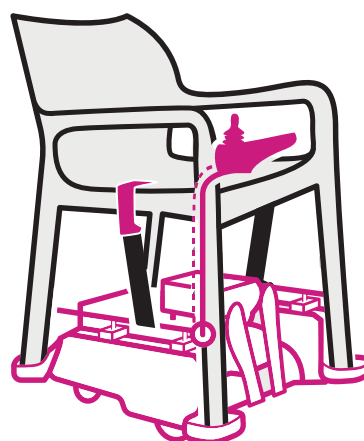
Chaise sans barreaux : utiliser les équerres
