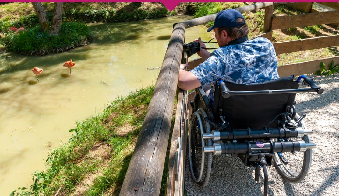
Le Maxi MINOTOR 2.1 est conçu pour les utilisateurs de fauteuils roulants dont le poids est supérieur à 120 kg. Equipé de 4 moteurs de 130 W il vous permettra de profiter des avantages des motorisations légères. Il s'adapte sur tous les fauteuils pliants quelle que soit la largeur et grâce à la batterie Lithium-ion de 18 Ah vous avez une autonomie d'au moins 20 km.
