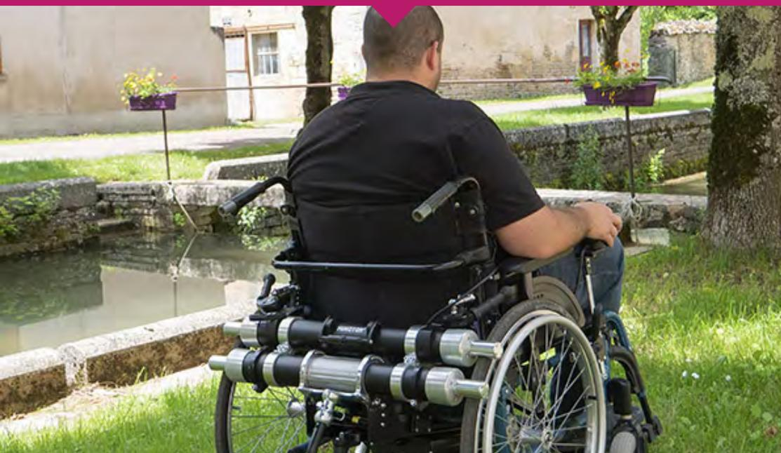
Le Maxi MINOTOR 2.1 est conçu pour les utilisateurs de fauteuils roulants dont le poids est supérieur à 130 kg. Equipé de 4 moteurs de 130 W il vous permettra de profiter des avantages des motorisations légères. Il s'adapte sur tous les fauteuils pliants quelle que soit la largeur et grâce à la batterie Lithium de 18 Ah vous avez une autonomie d'au moins 20 km.
