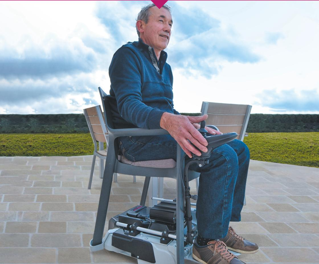
Cette motorisation se présente sous la forme d'un support composé d'un moteur sur 4 roues et s'adapte à 80% des sièges afin de les rendre mobiles. Grâce à son faible encombrement, au joystick et au repose-pieds, le MOBILI KIT vous permet de circuler en toute sécurité même dans des endroits exigus.
