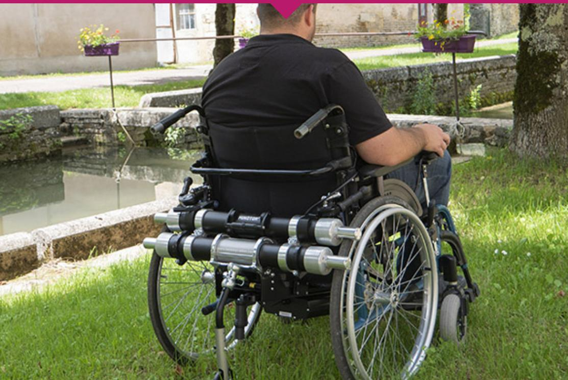
Le Maxi MINOTOR<sup>2</sup> est conçu pour les utilisateurs de fauteuils roulants dont le poids est supérieur à 130 kg. Equipé de 4 moteurs de 130 W il vous permettra de profiter des avantages des motorisations légères. Il s'adapte sur tous les fauteuils pliants quelle que soit la largeur et grâce à la batterie Lithium de 18 Ah vous avez une autonomie d'au moins 20 km.
