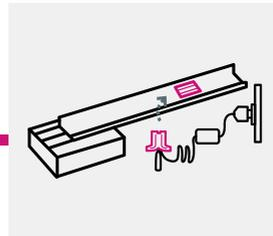
Schließen Sie dann das Ladegerät an die Stromversorgung an. Trennen Sie die Verbindung, sobald der Ladevorgang abgeschlossen ist.
