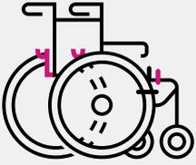
Ihr Rollstuhl ist mit **Hakenstangen und Haken** ausgestattet, die es Ihnen ermöglichen, Ihr elektrisches Power Add-On sehr schnell anzubringen. An der Vorderseite Ihres Rollstuhls befindet sich eine **Halterung für die Steuerung**, die den Joystick aufnimmt.
