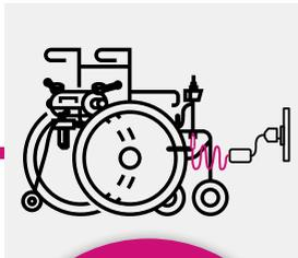
Wenn die Batterie ausgebaut ist, schließen Sie das Ladegerät an den roten Anschluss der Batterie an.
