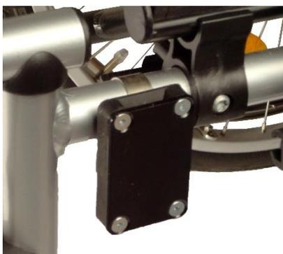
La glissière est installée de manière permanente par simple vissage sur le châssis du fauteuil
